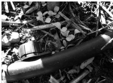
Préférer les goutteurs pouvant se dévisser pour les nettoyer
