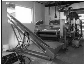
Le jus filtre à travers les perforations du tapis, s'écoule dans un récipient avant d'être repris par pompage vers le filtre. Le jus, auparavant additionné de perlite, argile qui va fixer les particules en suspension qui se déposeraient sur plusieurs centimètres au fond des bouteilles sans cette opération, est envoyé sous pression à travers le filtre à tamis ; il traverse ainsi plusieurs dizaines de mètres de tissu avant de ressortir quasiment limpide à l'autre extrémité.
